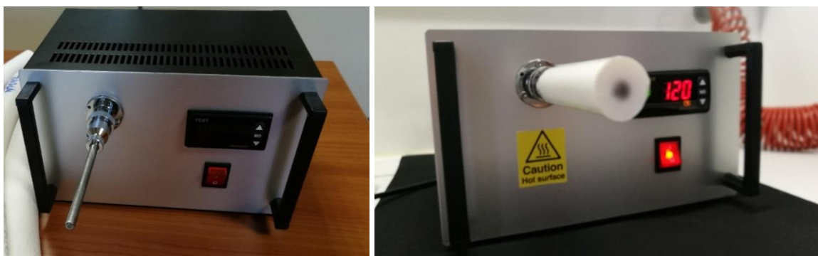
Εικόνα 2.5 Φωτογραφίες μετρητικής διάταξης για τον έλεγχο μονωτικών υλικών χαλκοσωλήνων ως προς την αντοχή τους σε υψηλές θερμοκρασίες
